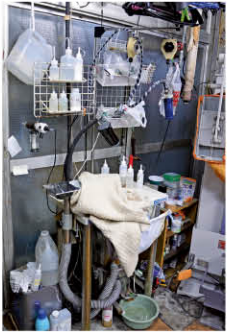
水と蒸気の出るノズルが左右に、速乾のためにドライヤー、下に吸引口がある。
