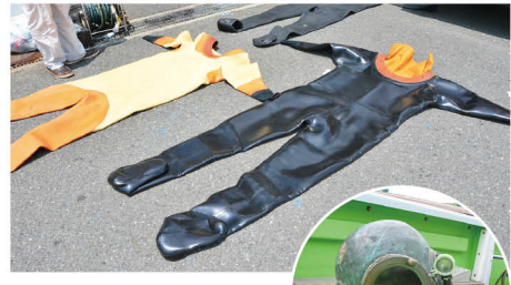
上:潜水服 右:ヘルメットと鍮(しごろ)ヘルメットと潜水服をつなぐ蝶の部分
